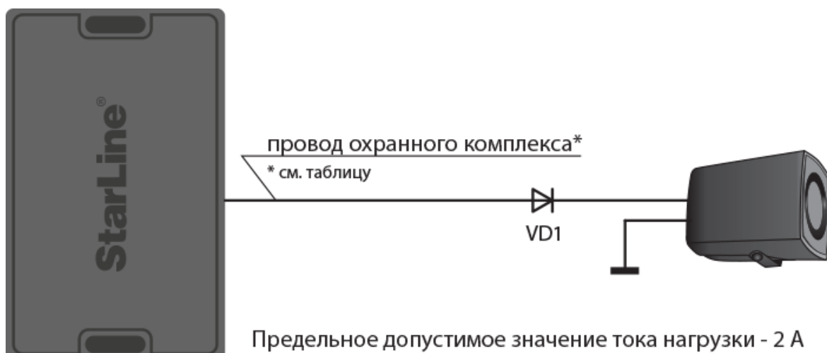
Схема подключения автомобильной сирены
