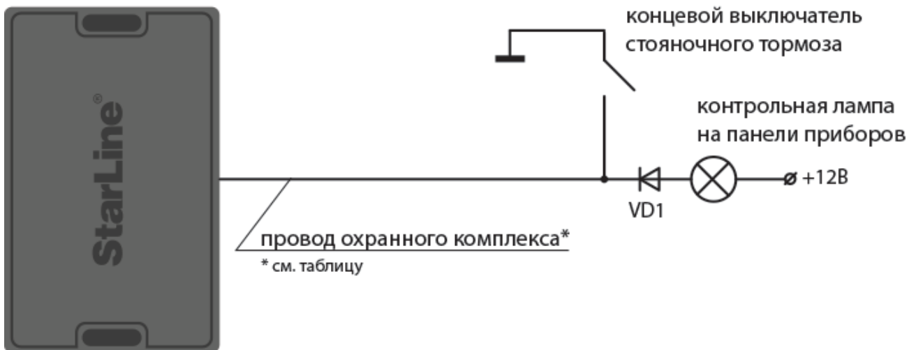
Схема подключения стояночного тормоза
